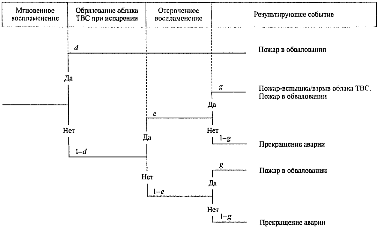
Рис. 4. «Дерево событий» разрушения/перелива подземного резервуара (сценарий А 4 )
